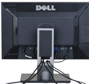
Después de conectar al monitor y al equipo todos los cables necesarios, (consulte la sección "[Conexión de los cables](#)" para la conexión del cableado) use la guía de cables para ordenar cuidadosamente todos los cables como se muestra arriba.
